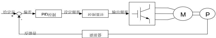
图 5.36 PID 控制基本原理框图
