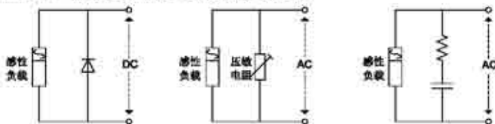
图 3-20 感性负载安装浪涌抑制装置
